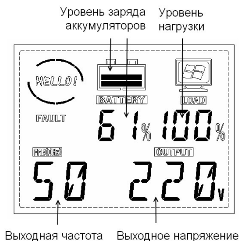
Показания дисплея в режиме работы «от батарей»
